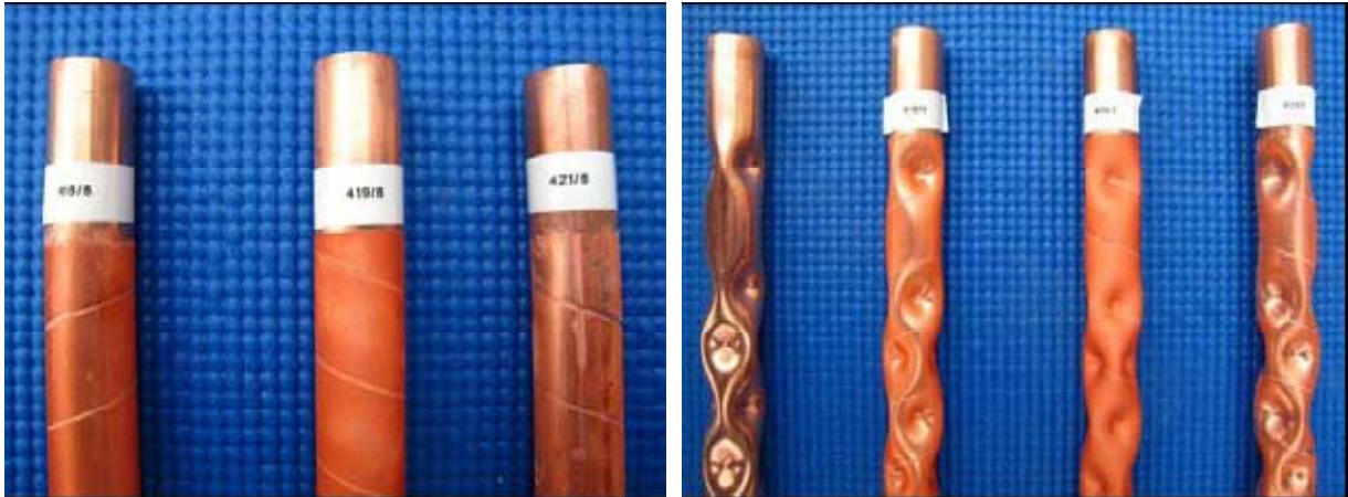
Abbildung 2: Mikro- und Makrostrukturierte Verdampferrohre
